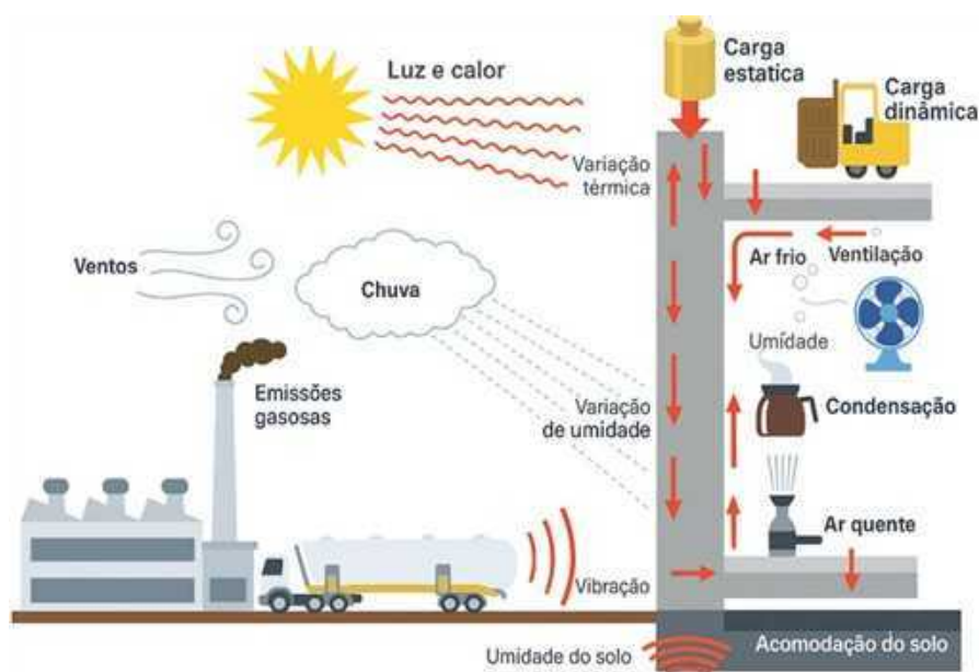
Figura 1 - Solicitações sobre os revestimentos de fachada
