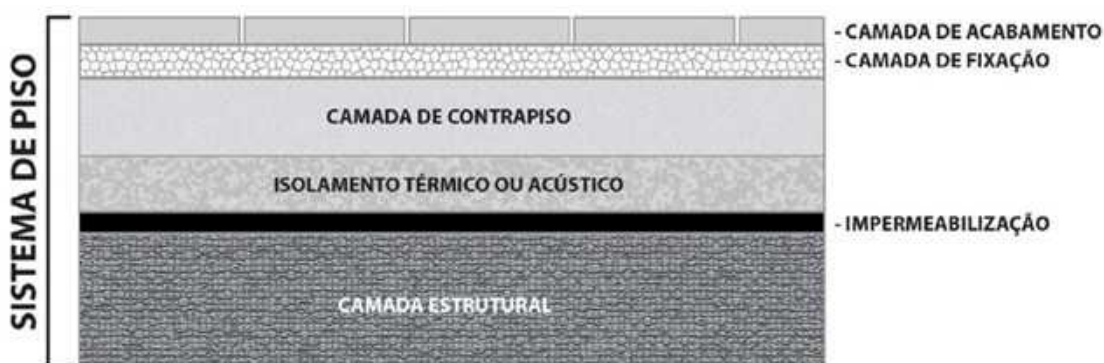
Figura 1 – Exemplo genérico de um sistema de piso e suas camadas
