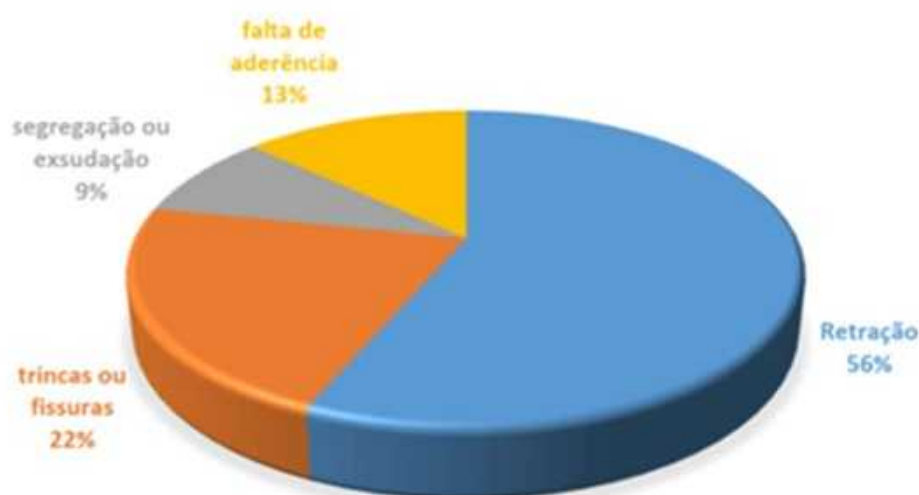
Figura 4 – Principais manifestações patológicas em contrapiso com argamassa fluida
