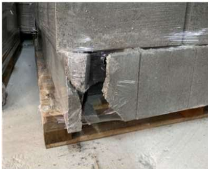
Figura 17. Parte do bloco extrapolando a área do palete resultando em quebra.
