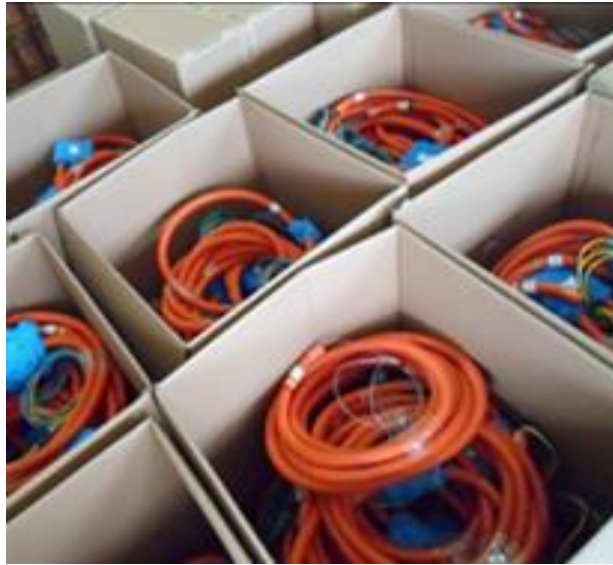
Figura 8 – Armazenamento no almoxarifado por tipo de apartamento (sistema polvo)
