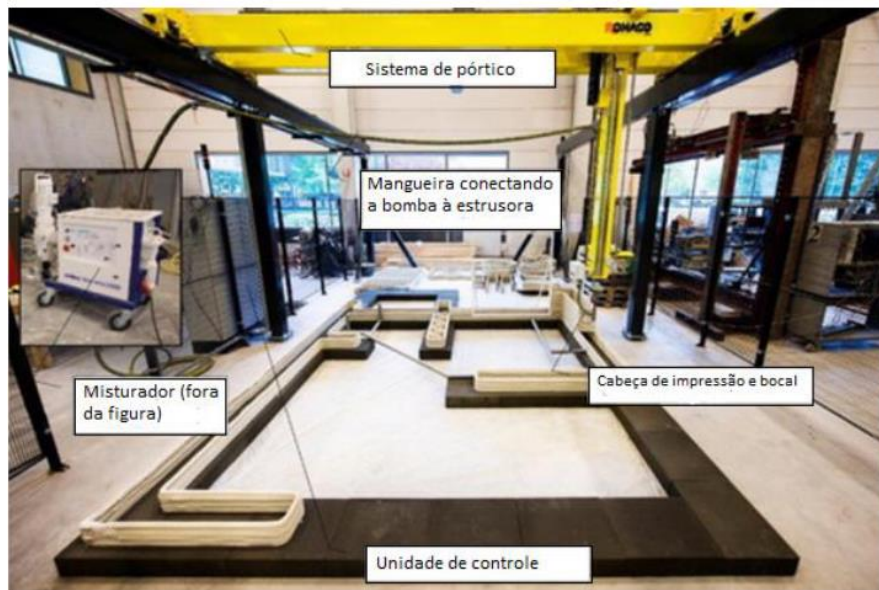
Figura 5- Impressora 3D de concreto de pórtico
