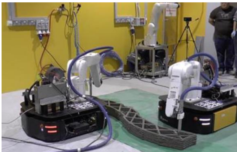
Figura 7- Impressão 3D de concreto por um grupo de robôs móveis
