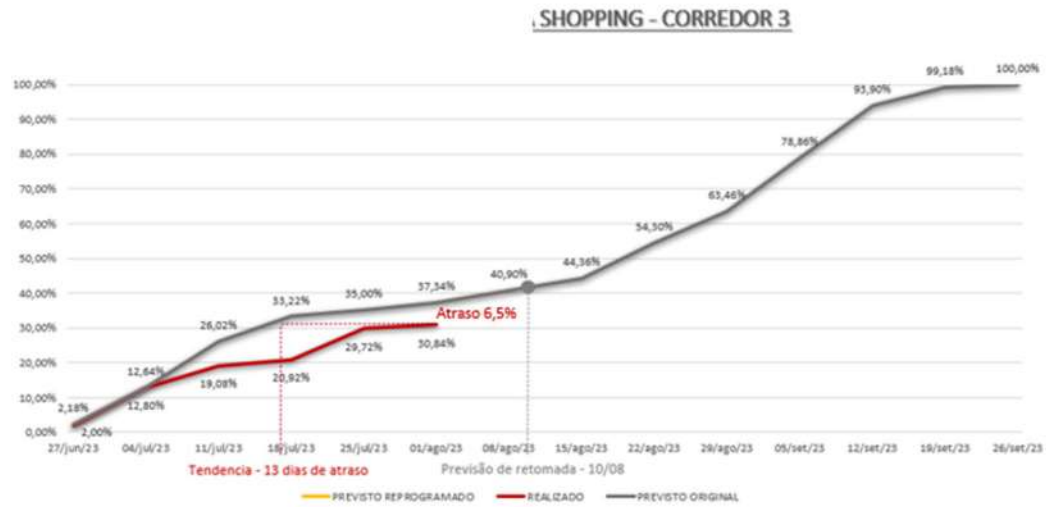
Figura 49- Gráfico de curva S indicando atraso de obra – Obra 4 Cliente B
