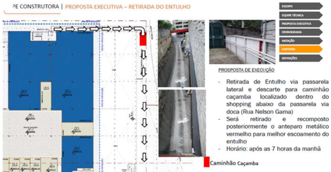
Figura 22 – Plano de retirada de resíduos – Obra 2, Cliente A
