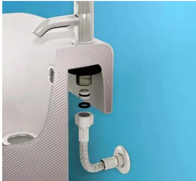
Figura 15: Restritor de vazão em pias ou lavatórios
