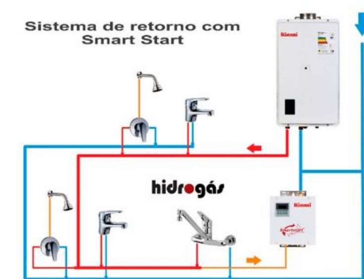
Figura 21: Recirculador de Água Quente (Esquema)
