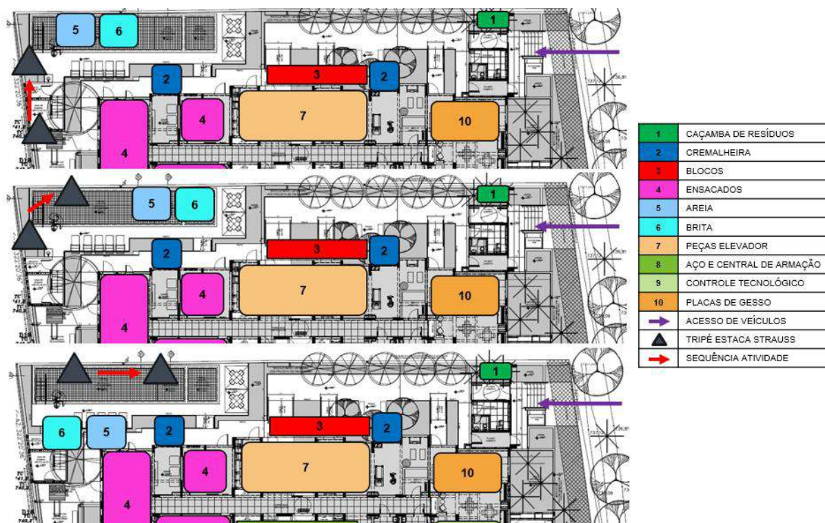
Figura 34– Movimentação de equipamento e materiais na execução de estaca Strauss – Caso A
