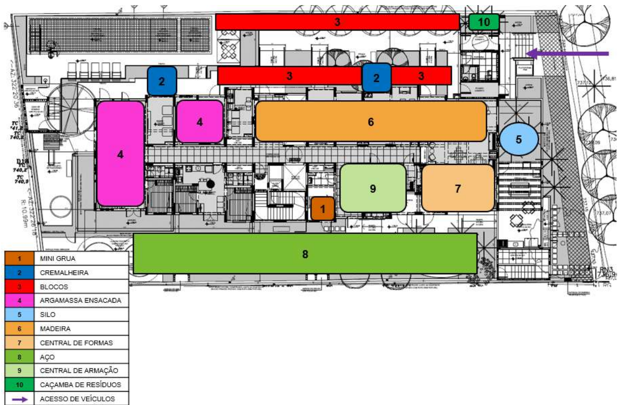
Figura 26 - Projeto de Canteiro Aplicado – Caso A
