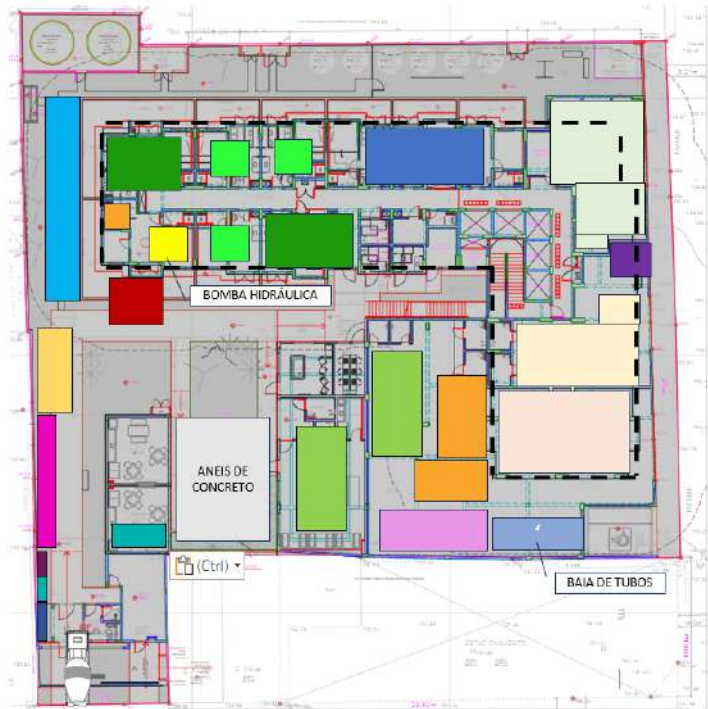
Figura 45 - Layout do canteiro na fase de acabamento e infraestrutura enterrada - Caso B
