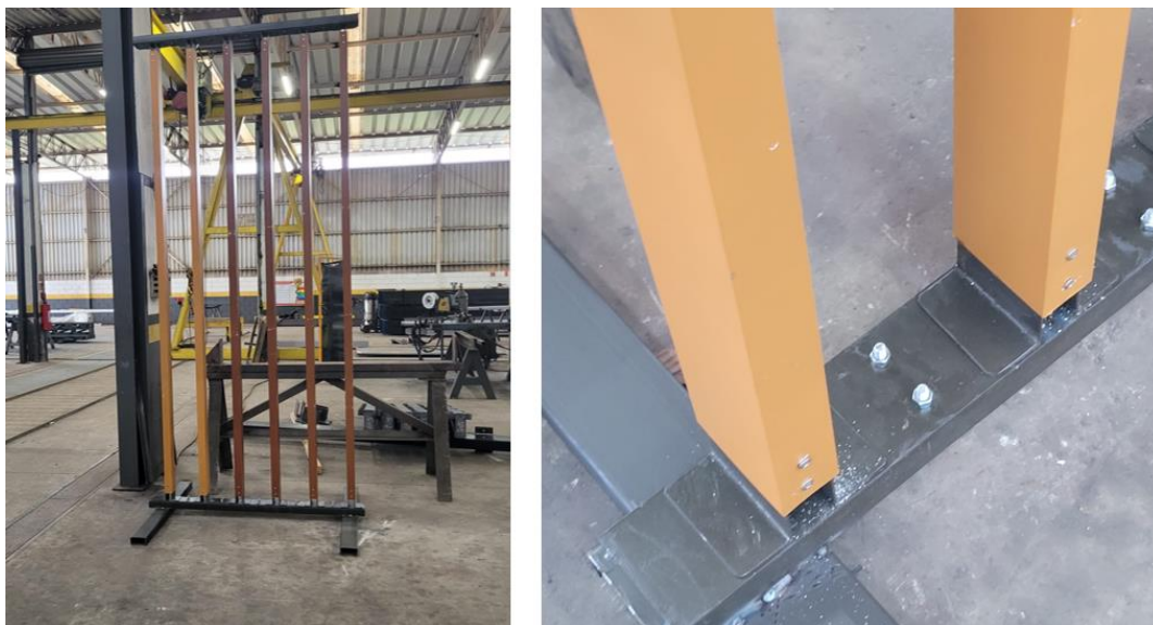
Figura 29 – Exemplo de protótipo de brise metálico
