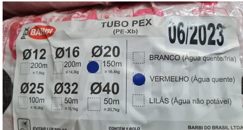
Figura 76: Identificação rolo tubo PEX.
