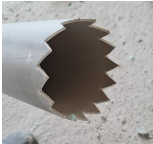
Figura 83: Tubo preparado para furar passante em espuma.
