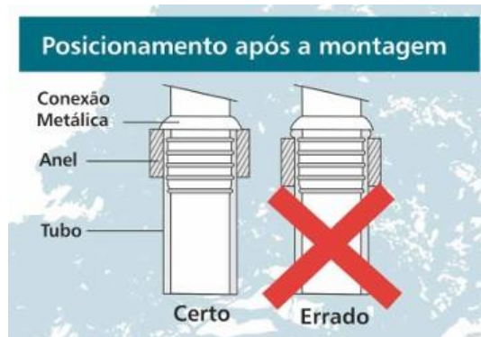
Figura 29: Tubo e conexão após montagem.
