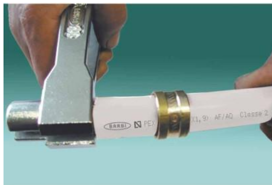
Figura 25: Ajuste da extremidade do tubo com alargador.
