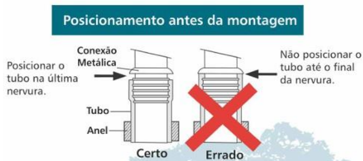
Figura 27: Detalhe de posicionamento entre tubo e conexão.
