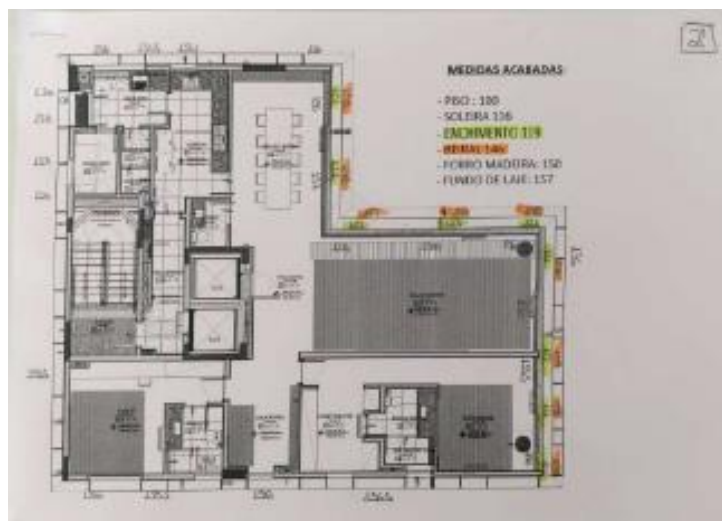
Figura 27- Mapeamento de cotas estrutural x acabado
