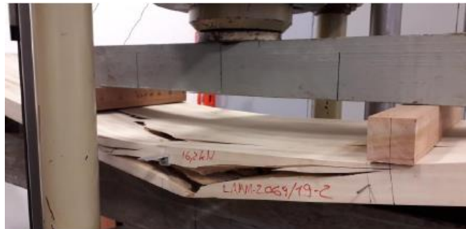
Figura 30- Detalhe de ruptura no corpo de prova
