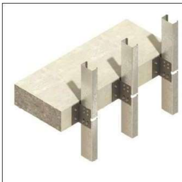
Figura 8 - Conector fixado na estrutura e perfil montante
