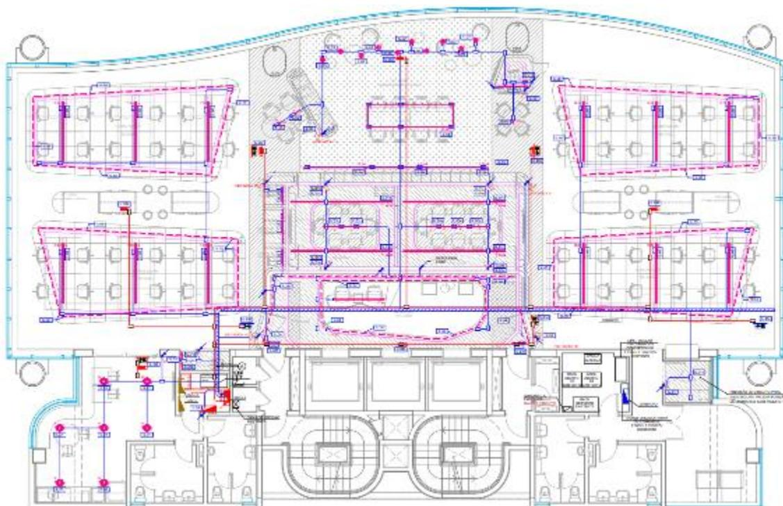
A Figura 52 foi retirada do projeto Instalações Elétricas - 3º Andar – Infraestrutura e Distribuição Elétrica - Iluminação. Neste projeto, coletavam-se informações de quantas luminárias precisavam ser instaladas no pavimento. Isto quer dizer o seguinte: que as informações de quantidades de serviços usadas para mensurar a produtividade da mão de obra nos serviços de instalação de luminárias, foram extraídas destes tipos de projeto.
