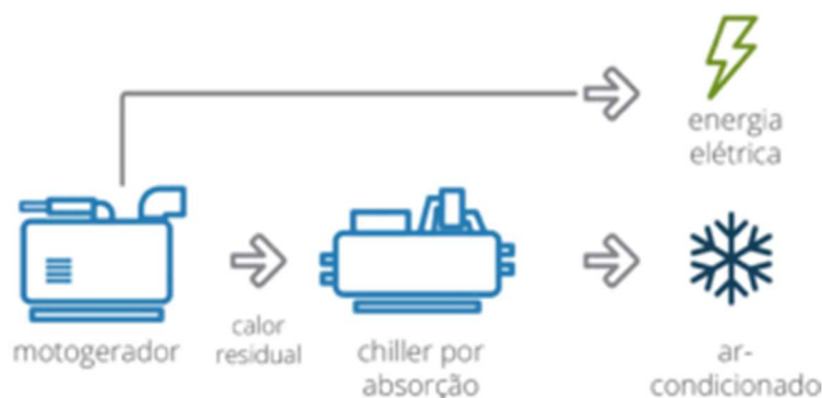
Figura 23 – Sistema de Cogeração de Energia
