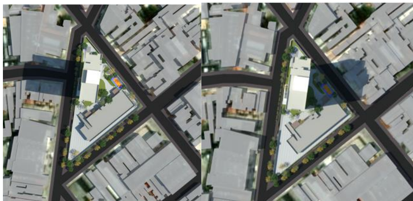
Figura 12 – Estudo da insolação do Empreendimento 2, no solstício de verão, às 9h e às 15h
