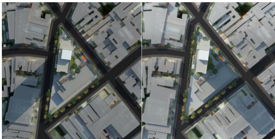
Figura 13 – Estudo da insolação do Empreendimento 2, no solstício de inverno, às 9h30 e às 15h30
