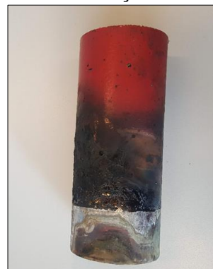
Figura 3.35 – Falha em soldagem de tubulação do Subsolo
