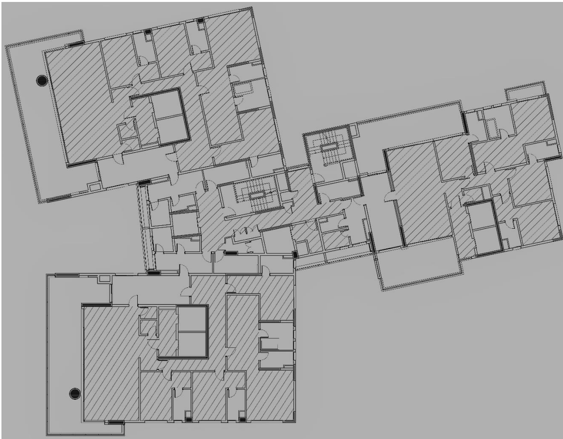
Figura 28 – Planta de um pavimento tipo da Obra 1, indicando os ambientes nos quais as paredes eram revestidas em gesso
