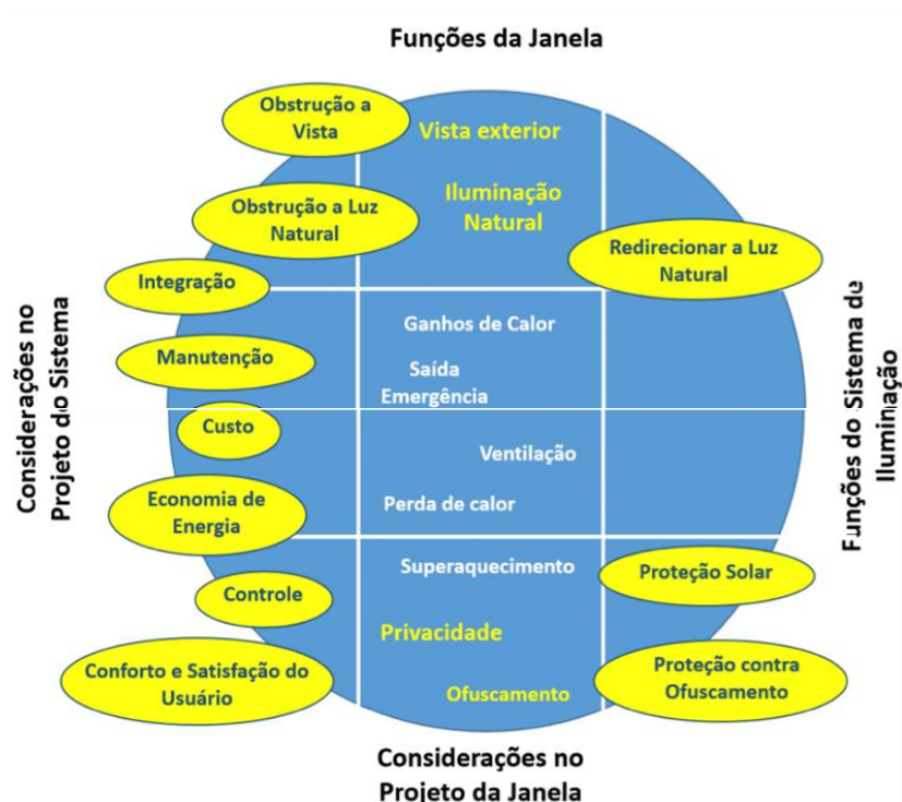
Figura 2 – Funções e considerações para o projeto de janela e sistemas de iluminação natural
