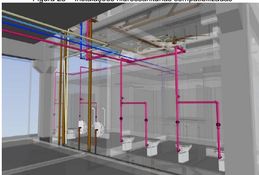
Figura 25 – Instalações hidrossanitárias compatibilizadas
