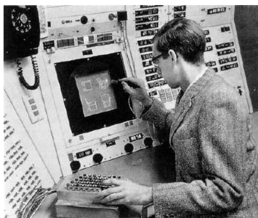
Figura 1 - Ivan Sutherland, precursor do uso de computadores para desenvolvimento de projetos, utilizando a ferramenta de desenho computacional SketchPad
