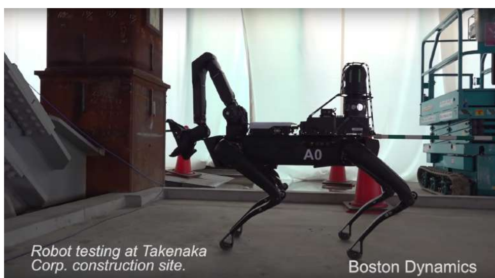
Figura 31 - Simulação de inspeção visual de obra realizado por robô autônomo da empresa norte-americana Boston Robotics em obra da construtora Takenaka, no Japão
