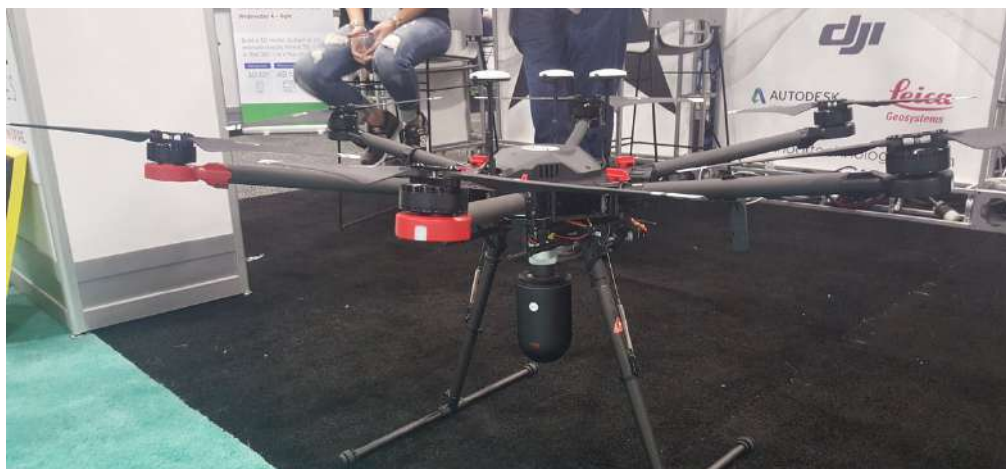
Figura 27 - Drone com escaneamento a laser com o Leica BLK360 no Autodesk University de 2017 em Las Vegas
