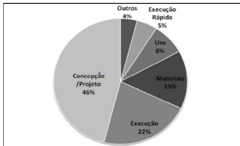
Figura 6 - Origem das patologias na construção civil
