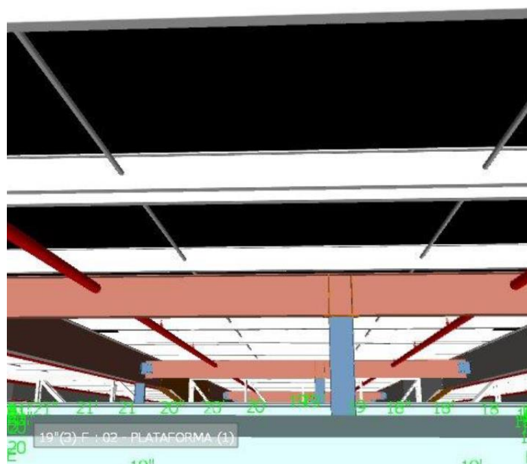
Figura 17: Colisões com sistema de proteção contra incêndio e estruturas metálicas auxiliares – entre eixo 19 e 19'
