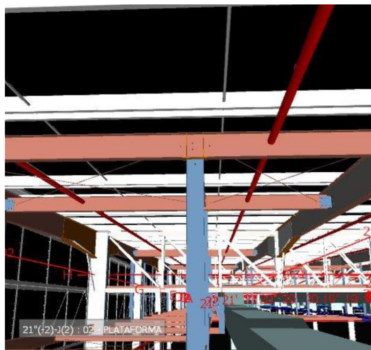
Figura 16: Colisões com sistema de proteção contra incêndio e estruturas metálicas auxiliares – no eixo 22
