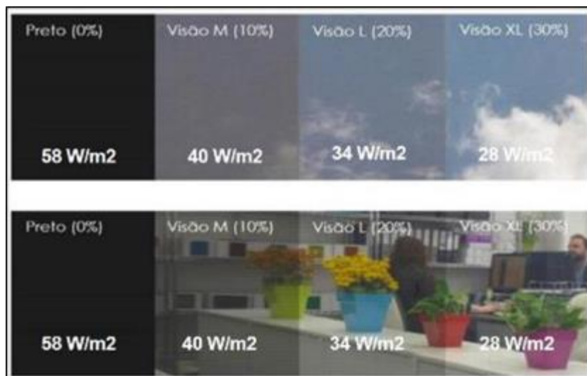
Figura 9 - Níveis de transparência e potência de geração em vidros fotovoltaicos silício amorfo
