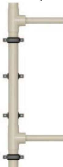
Figura 24 - Fixação de abraçadeiras fixas e deslizantes
