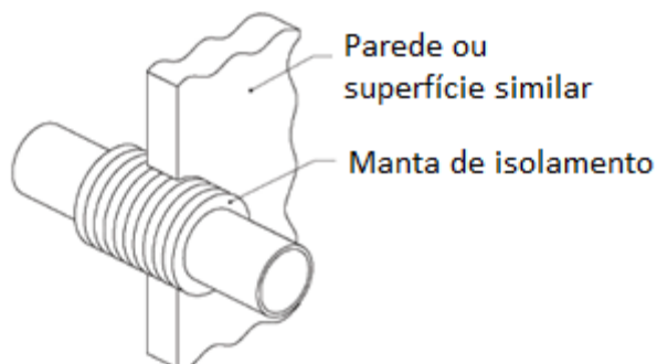
Figura 30 - Isolamento de tubulações em contato com paredes
