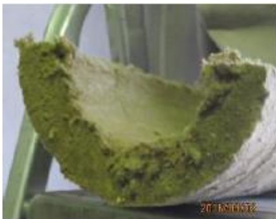
Figura 51 - Tubo bipartido de lã de rocha (material 5)
