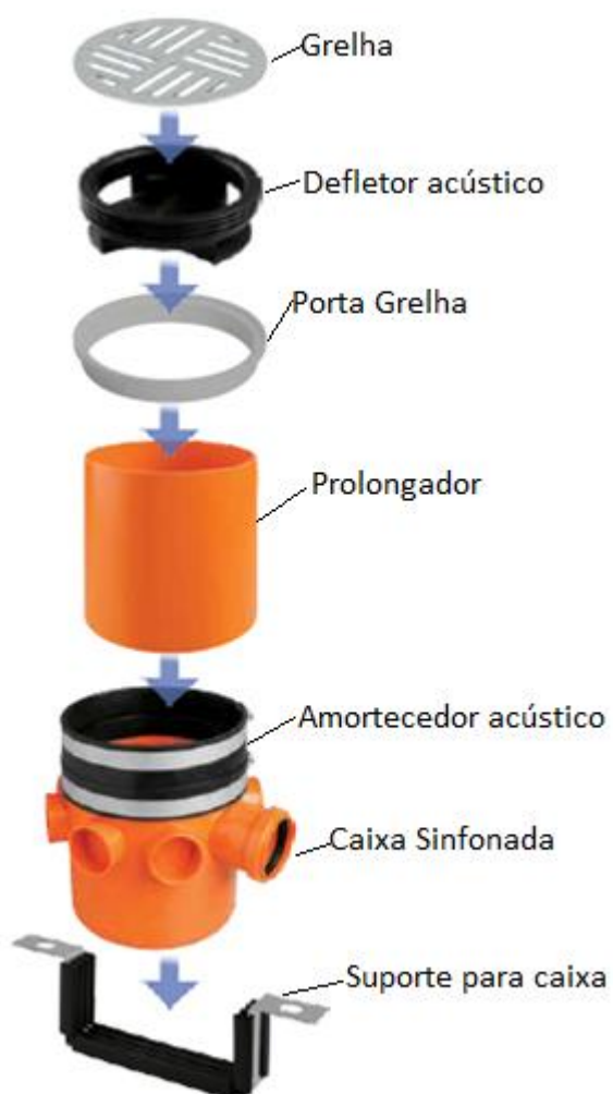
Figura 59 - Detalhe da Caixa Sifonada
