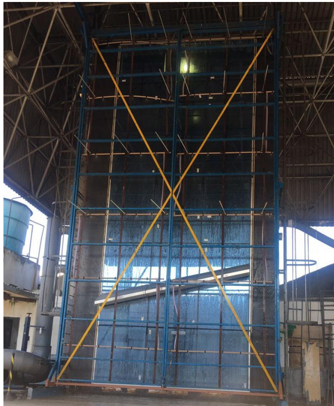
Figura 7 – Módulo de ensaio ITEC (estanqueidade e pressão)
