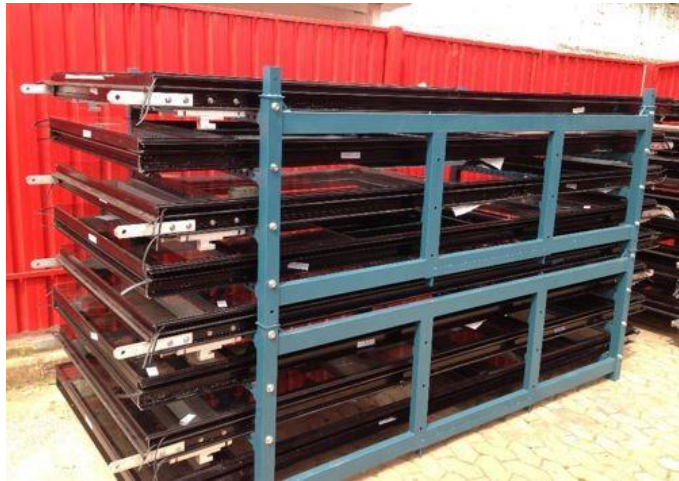
Figura 3 – Rack metálico modular para transporte dos módulos
