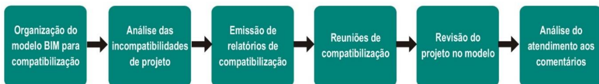
Figura 4 - Etapas do processo de Compatibilização - Fonte: Guia Asbea de Boas Práticas em BIM Fascículo II (2015) - p.19
