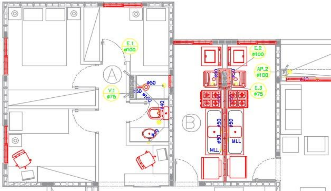
Figura 42 – Localização dos pontos hidráulicos
