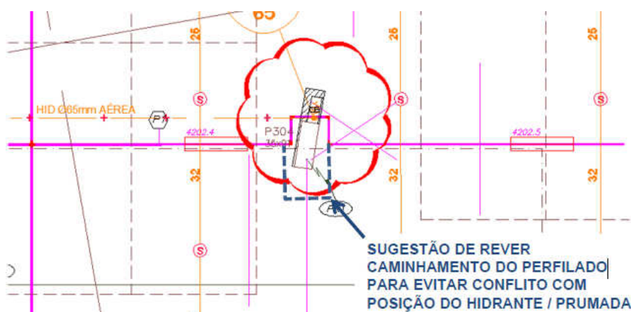
Figura 8 - Caminhamento de elétrica em conflito com prumada de hidráulica
