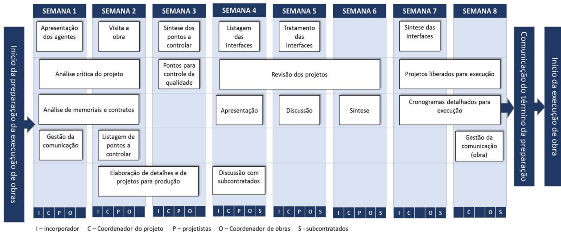
Figura 72: Exemplo de planejamento geral das reuniões coletivas de PEO Fonte: Souza e Melhado (2003), adaptado pela autora
