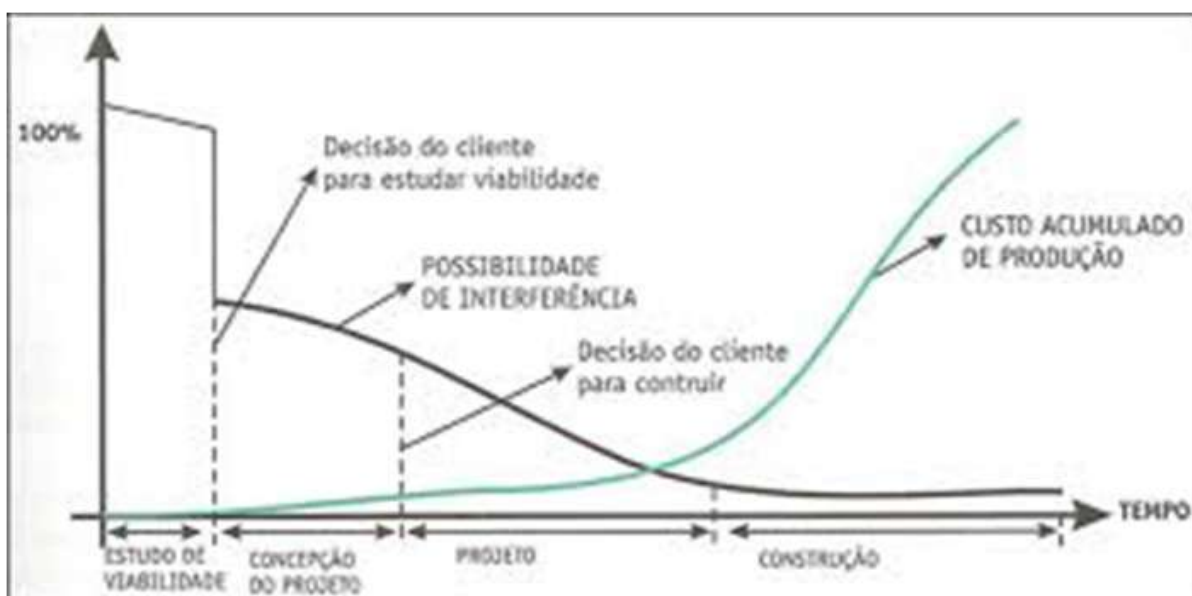
Figura 6 – O avanço do empreendimento em relação à chance de reduzir o custo de falhas do edifício
