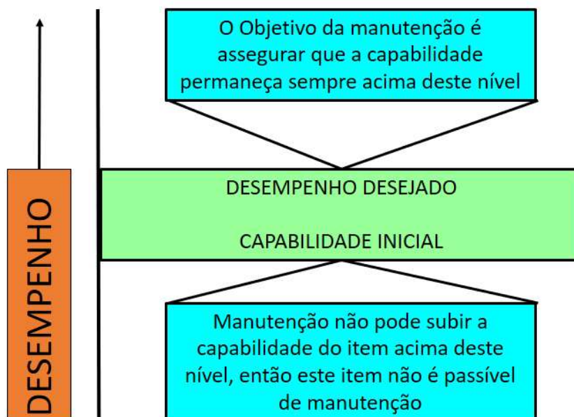
Figura 3.2 – Uma situação não passível de manutenção
