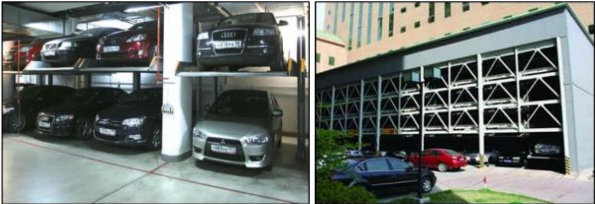
*Figura 10 – Edifício garagem com solução mista (Moscou, Rússia)*
