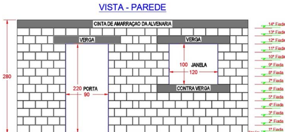
Figura 18: Vergas e contravergas executadas em pré-moldados
