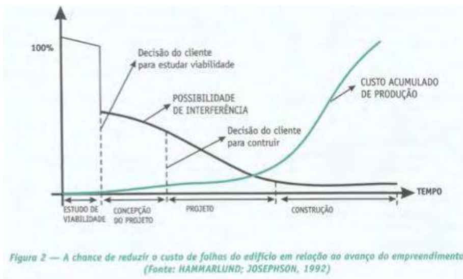
Figura 11: Gráfico influência das decisões na fase de projeto na redução do custo
