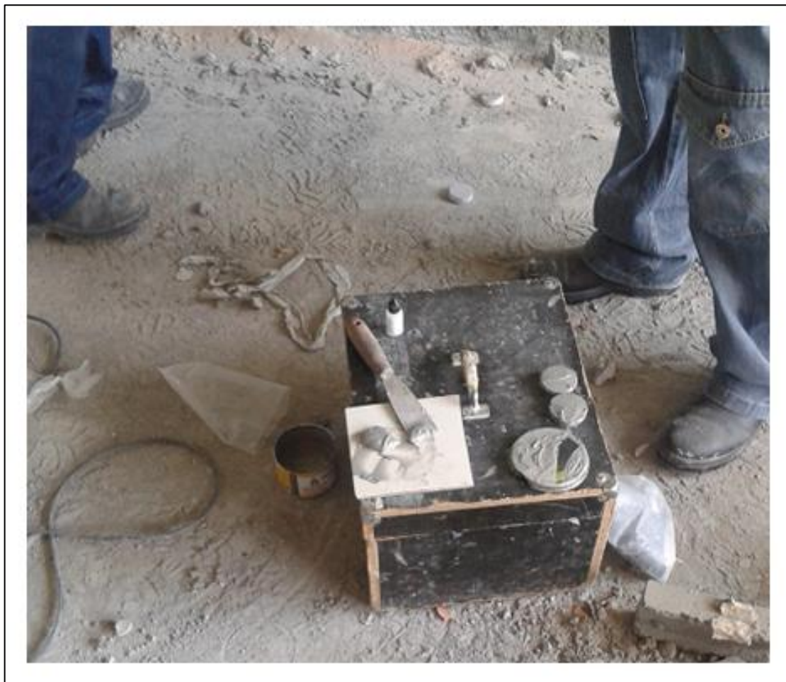
Figura 21 - Pastilhas com massa plástica para colagem .
