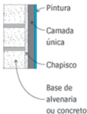
Figura 5 - Ilustração das principais camadas do revestimento.
