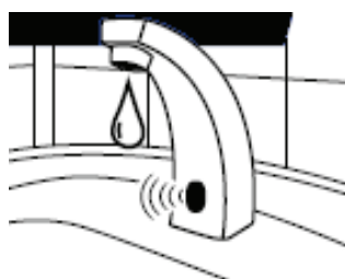
Figura 6 – Exemplo de sensor de presença em torneiras e maçanetas tipo alavanca.
