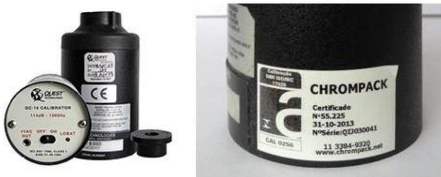
Figura 6 – Calibrador QC-10 e Selo de calibração
