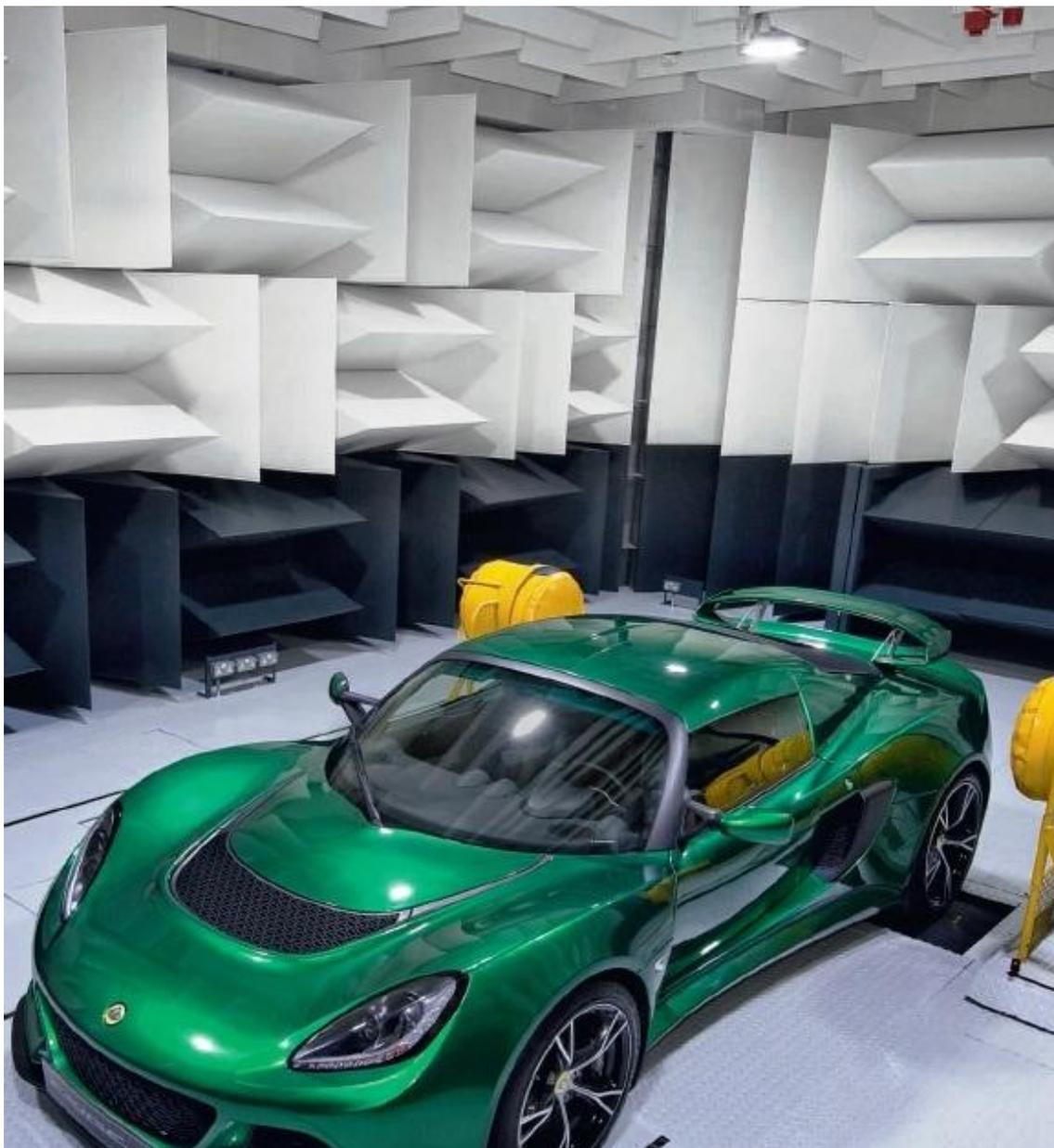
A câmara acima é da montadora Lotus semi-anecóica com o Cut-Off de 70 Hz.
