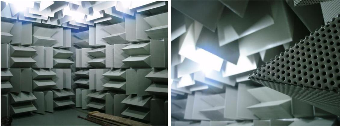
Foto da finalização e do detalhe da cunha metálica.
