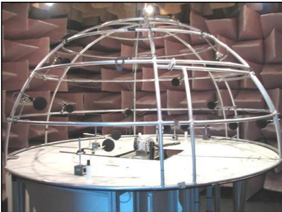
**Figura 05:** Sistema de posicionamento de microfones.
