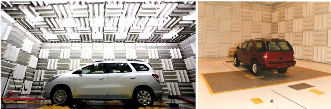
A câmara semi-anecóica acima foi instalada no campo de provas da GM em Indaiatuba-SP, após os testes ficou certificado o *Cut-Off* de 100 Hz.
