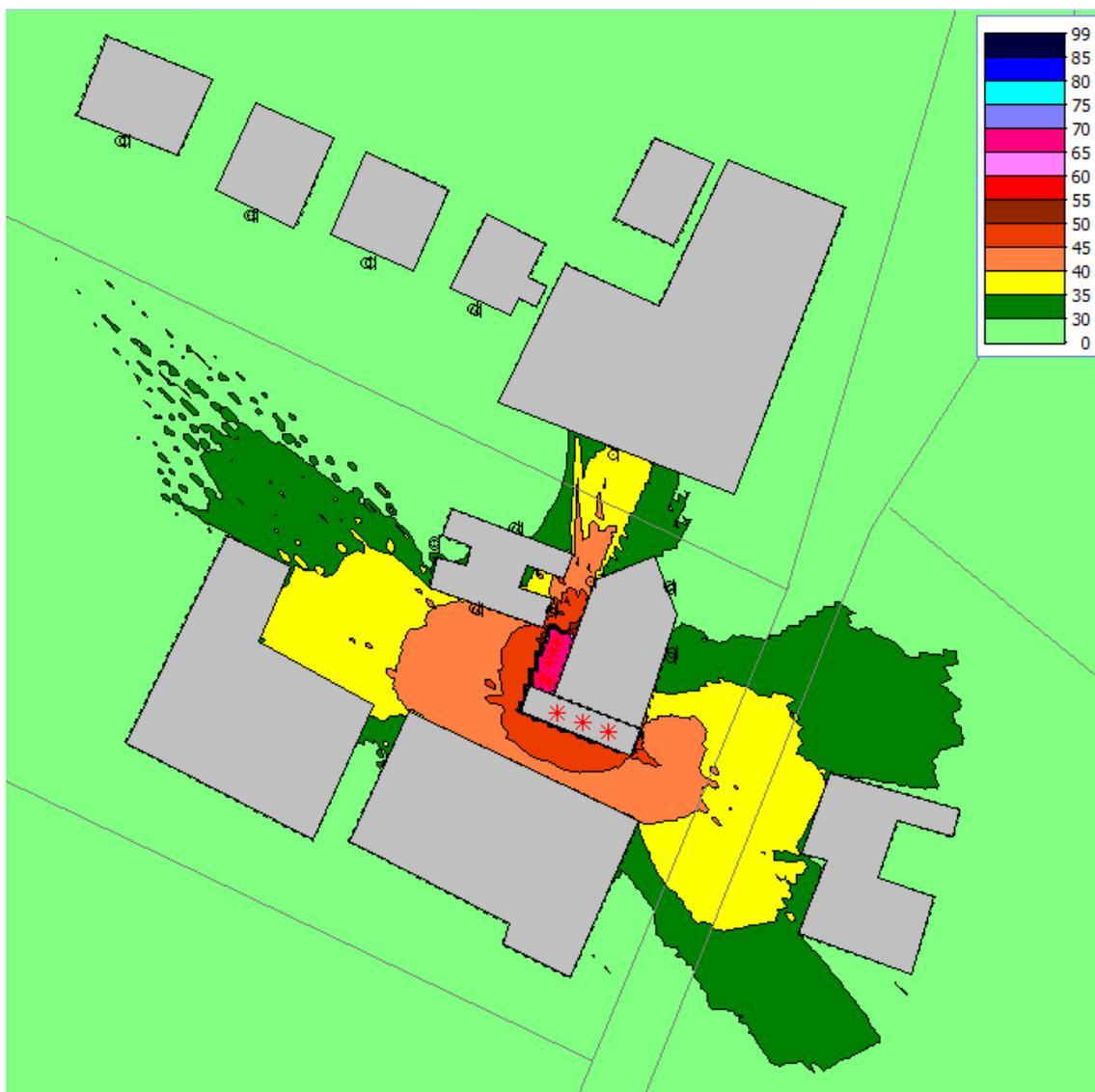
Figura 12- Vista superior da simulação computacional com barreira acústica.
