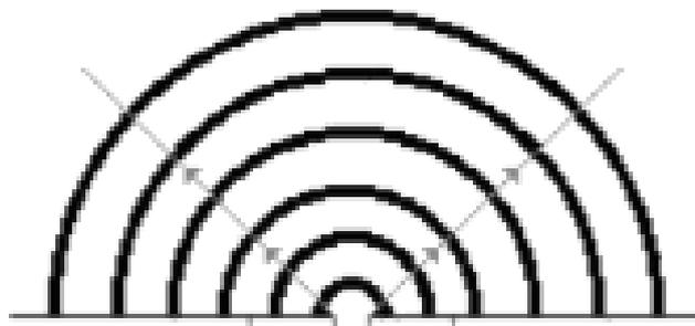
Figura 6- Propagação do som em onda semi-esférica.
