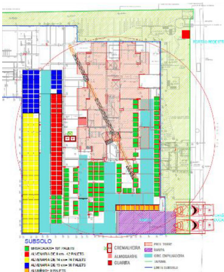
Figura 29 – Áreas de armazenamento nos subsolos em um canteiro de obras
