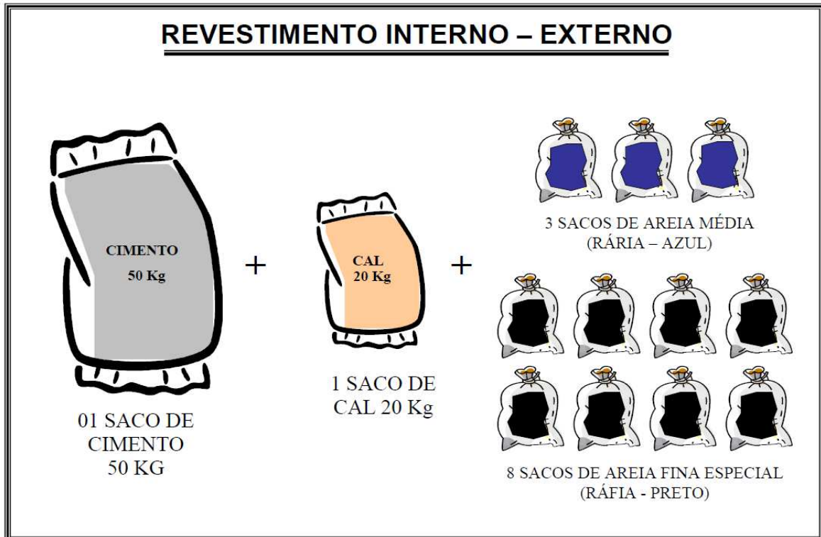
Figura 10: Traço de argamassa de revestimento com agregado natural.
