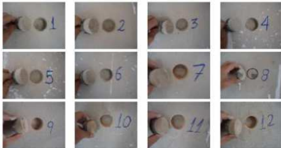
Foto 01 - Visualização dos corpos de prova 01 ao 12 após ruptura
