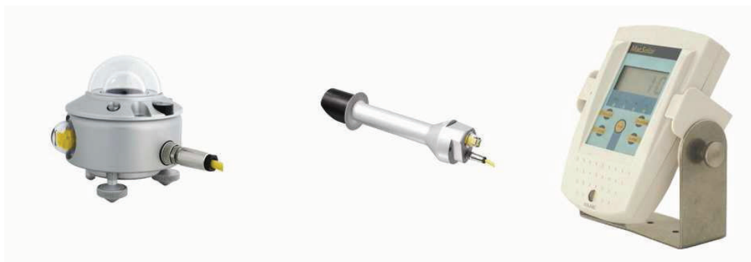
Figura 4: À esquerda, piranômetro (fonte: Kipp&Zonen); Ao centro, um pireliômetro (Fonte: Kipp&Zonen); direita aparelho com medidor de energia que utiliza sensores fotovoltaicos (Fonte: MacSolar).
