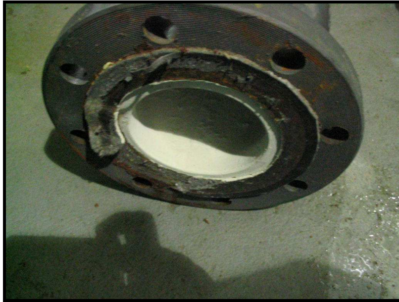
Figura 10 – Incrustação na cor branca em tubulação de água Fonte: Adaptação de Modelo Implantado em Data Center
