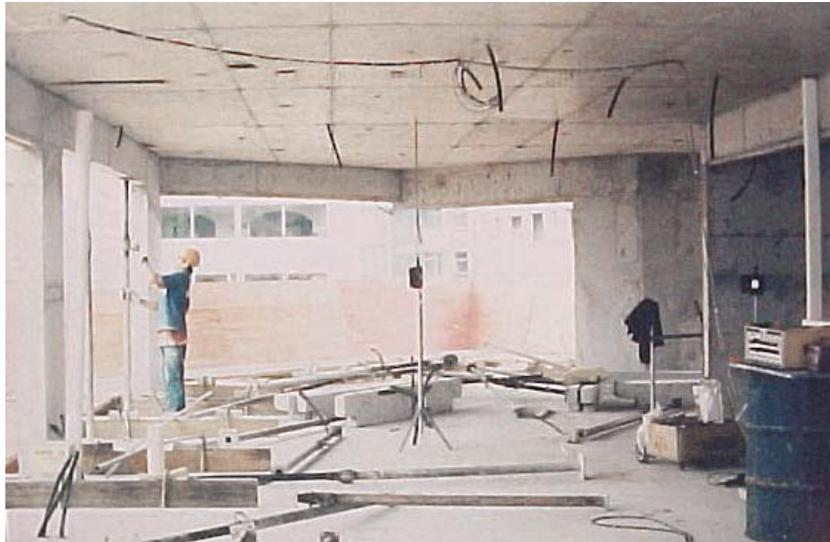
Figura 9.4 – Foto do deflectômetro mecânico instalado para leitura da flecha no ponto de maior deslocamento.
