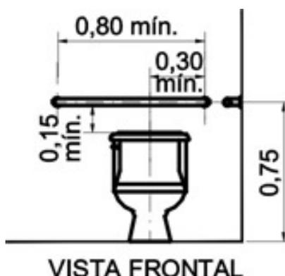
Figura 10: Bacia sanitária com caixa acoplada
