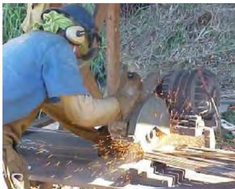
*Figura 3.41 – Máquina de corte elétrica (policorte).*
