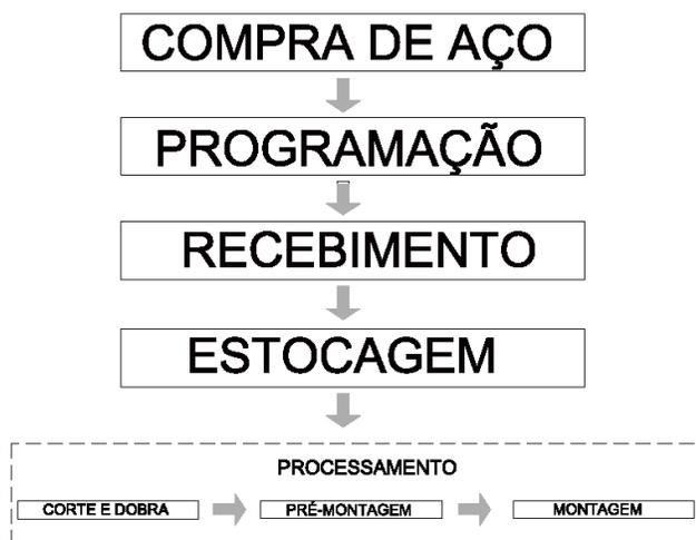
Figura 3.36 – Fluxograma de produção das armaduras para o aço entregue em barras.
