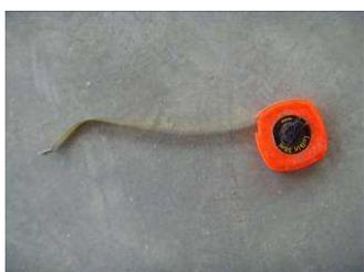
Figura 29 – Trena metálica de 30m.
