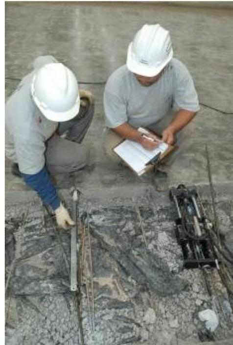
Figura 4.39 – Medição a planilhamento das cargas e alongamentos
