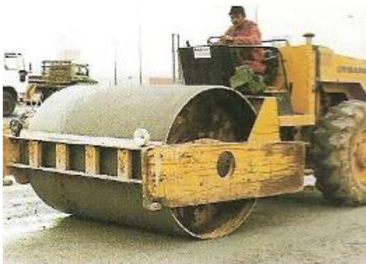
Figura 4.8 – Rolo compactador tipo liso
