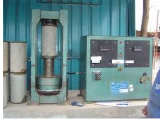
Figura 4.35 – Rompimento de corpos de prova
