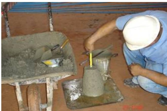
Figura 4.33 – Ensaio de abatimento
