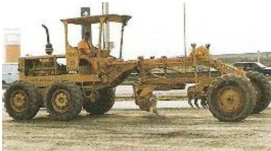
Figura 4.7 – Motoniveladora (Fonte ABCP s.d.)
