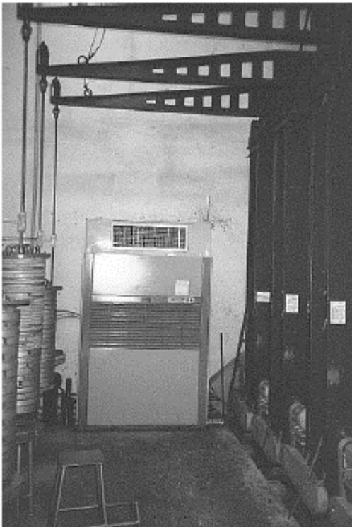
Figura 3.8.- Aparatos para ensaios de relaxação: através de contra-pesos se define a tensão no aço, mantendo seu comprimento constante. O ensaísta vai retirando contrapesos à medida que o comprimento do aço sofre alteração. Ao final do tempo especificado, sabe-se qual foi a queda de tensão em relação à tensão inicial. (Fonte : Belgo Bekaert)
