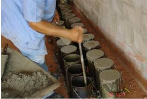
Figura 4.34 – Moldagem de corpos de prova
