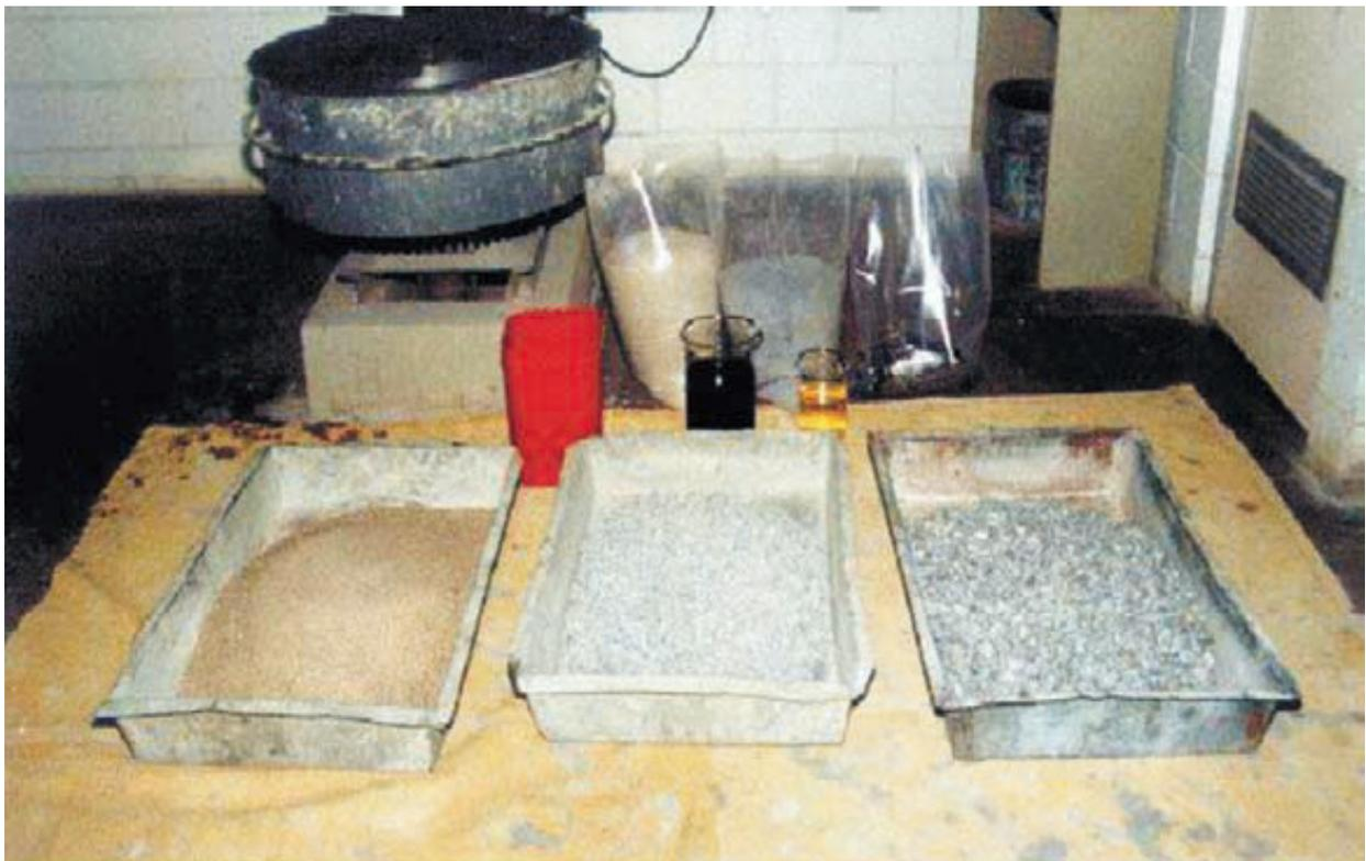
Figura 3.3 – Materiais constituintes do concreto para caracterização e dosagem. (Fonte ABCP s.d.)
