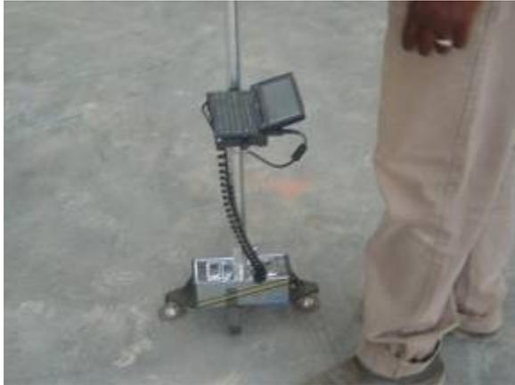
Figura 4.36 – Realização de Medição com *Dip Stick*
