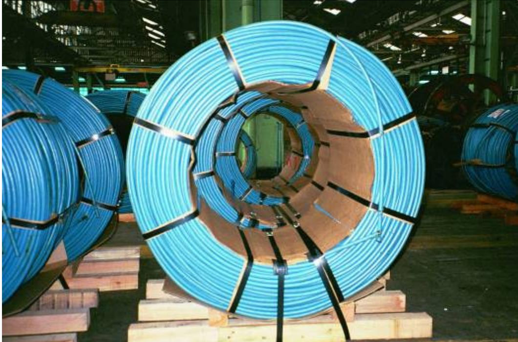
Figura 1.1 – Bobina de cordoalha engraxada e plastificada para protensão não aderente (Fonte Belgo Bekaert)
