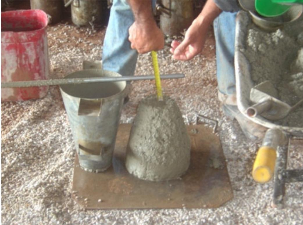
Figura 3.6 – Equipamento de medição do abatimento do tronco de cone (*Slump Test*).
