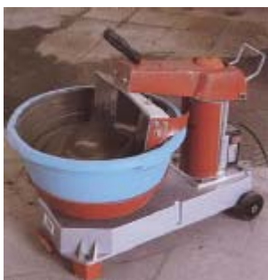
Figuras 4.9 e 4.10 – Misturador de base fixa. (Fonte: Catálogo do fabricante – Fermat Ind. E Comércio de Máquinas).
