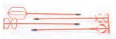
Figura 4.8 - Hastes helicoidais empregadas na mistura de argamassas colantes. Acoplada a uma furadeira profissional, permite a mistura da argamassa com água com rapidez e facilidade, tornando a argamassa mais homogênea. (fonte: Barros; Sabbatini, 2004)
