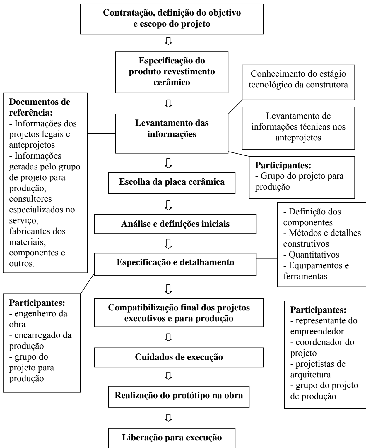
Figura 4.2 – Fluxograma simplificado de um processo de projeto para produção de revestimento cerâmico.
