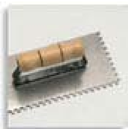
Figura 4.11 - Desempenadeira com dente de 6 x 6 x 6 mm, ideal para o assentamento de pastilhas de porcelana e vidro, inclusive cerâmicas menores que 20x20cm, em área interna. (Fonte: www.quartzolitweber.com.br )
