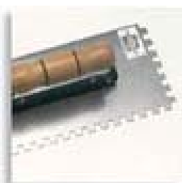
Figura 4.12 - Desempenadeira com dente de 8 x 8 x 8 mm para o assentamento de placa cerâmica em pisos e paredes, é a mais utilizada em revestimento interno. (Fonte: www.quartzolitweber.com.br )
