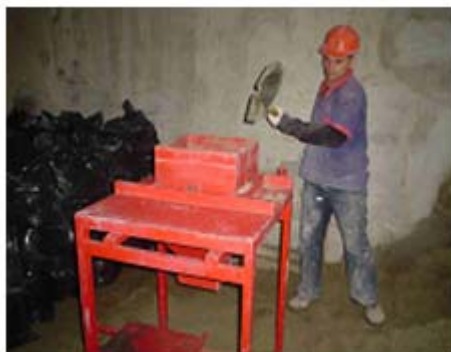
Figura 3.4 – Dosagem da areia com o uso de um dosador volumétrico.
