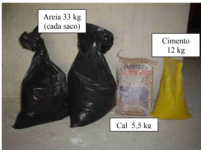
Figura 3.7 – materiais dosados no canteiro
