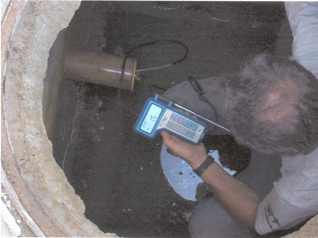
Ilustração 7-5 - Medição de velocidade de fluxo de gases (Kurozawa; Castro; Guedes - 2006)
