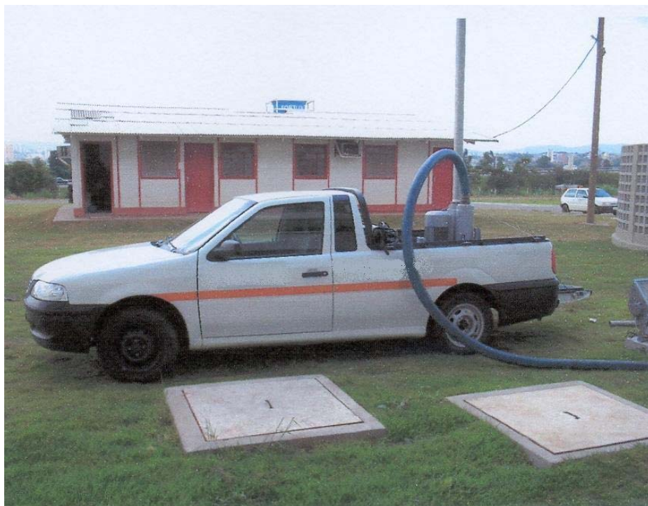
Ilustração 7-7 - Bomba utilizada na extração de VOC do teste piloto (Kurozawa; Castro; Guedes - 2006)
