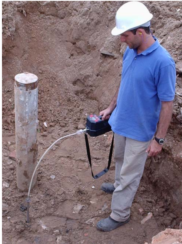
Ilustração 4-2 - Medição de gases (Soil Gas Survey) (Foto: Guedes B. P)
