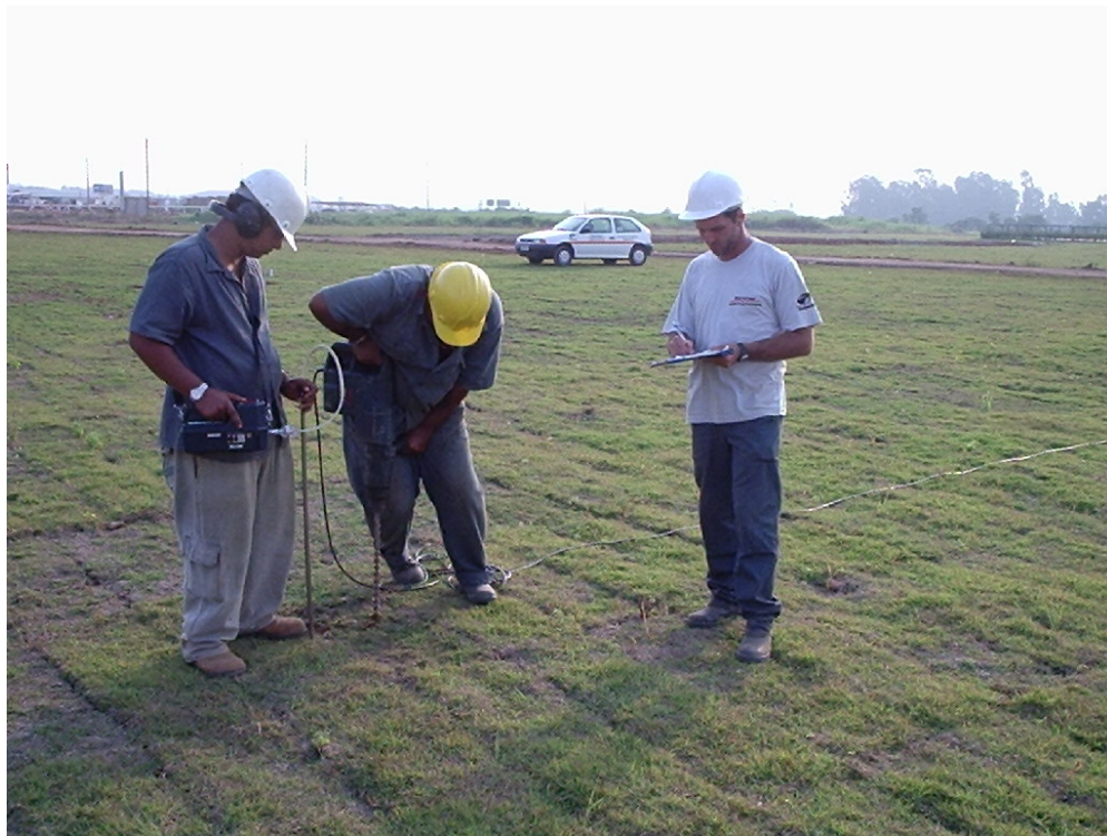
Ilustração 4-3 - Perfuração para medição de gases (Foto: Guedes B. P)
